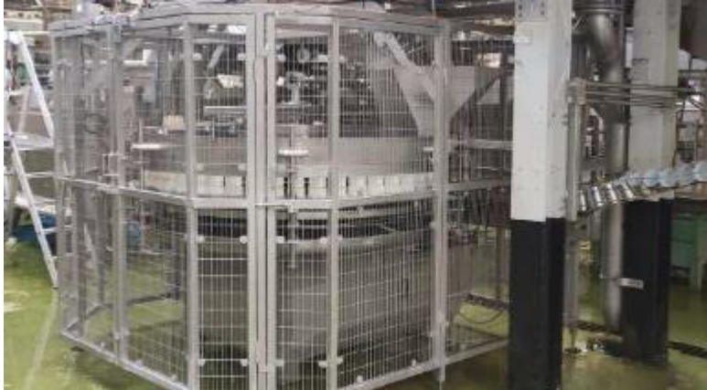
Figure 10 : nouvelle emboiteuse à poche
